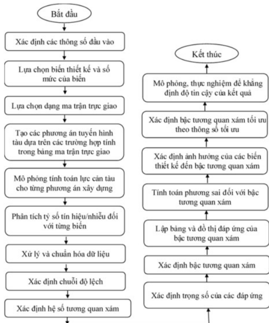
Hình 3.1. Quy trình các bước cải tiến hình dáng thân tàu hàng cấp VR-SB
